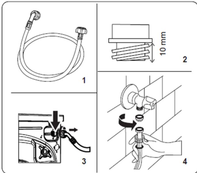
Raccordement d'un tuyau d'arrivée d'eau à un robinet avec filetage.
