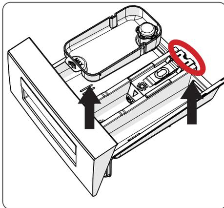
Retirer le tiroir à produits lessiviels et démonter le siphon adoucissant. Nettoyer soigneusement de manière à éliminer toute trace d'assouplissant. Une fois le nettoyage complété, monter à nouveau le siphon adoucissant et vérifier qu'il est correctement installé.
