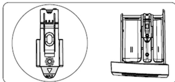
Ce compartiment est destiné aux assouplissants, aux adoucissants ou à l'amidon. Suivre les instructions figurant sur l'emballage. Si les assouplissants laissent des résidus après utilisation, essayez de les diluer ou d'utiliser un assouplissant liquide.
