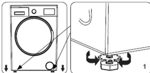
Le réglage du niveau de la machine s'effectue à l'aide des pieds ajustables.
