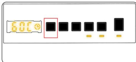
Utiliser la touche de réglage de la température de l'eau de lavage pour modifier la température prédéfinie d'un programme.
