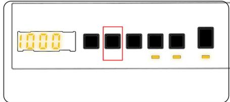
La vitesse d'essorage maximale du programme choisi est automatiquement proposée.
